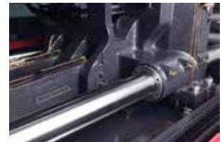
Sonlu elemanlar analizi ve optimizasyonu sonrasında Mengene Ünitesi, orta kısmı güçlendirilen ve geliştirilen kolon milleri, hızlı hareket ile, güçlü sertlikte plaka ve uzun ömürlü kolon milleri avantajlarına sahiptir.
